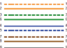
Schéma de câblage (T568B)
